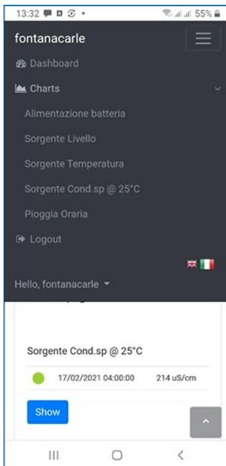
Una volta selezionato il sensore si passa alla visualizzazione dei dati con la possibilità di scegliere un intervallo temporale. Il massimo periodo visualizzabile è di 2 mesi di dati con funzione di autoscaling selezionabile:
